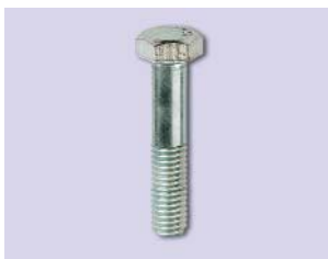
Болт для соединения ML-BM консолей с профилями PSL-PSM, DIN 931, оцинкованный, с частичной резьбой
