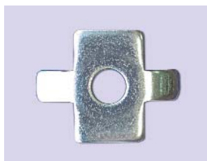
Шайба четырехлепестковая для соединения проволочного лотка (для использования с винтом M6x20)
